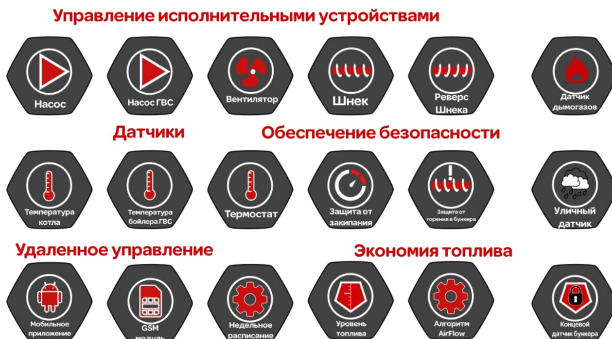
Рисунок 1. Основные функции контроллера автоматического котла DM350
